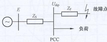
**图 B.1 电压暂降的电压分配器模型**
