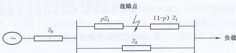
图 B.3 双回路供电系统等值电路
