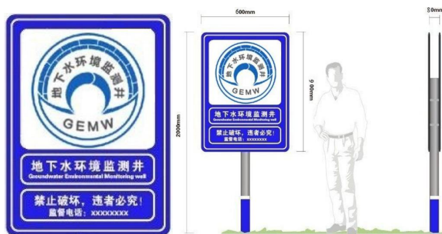
图 7.4-1 地下水监测井标识牌设置图例
