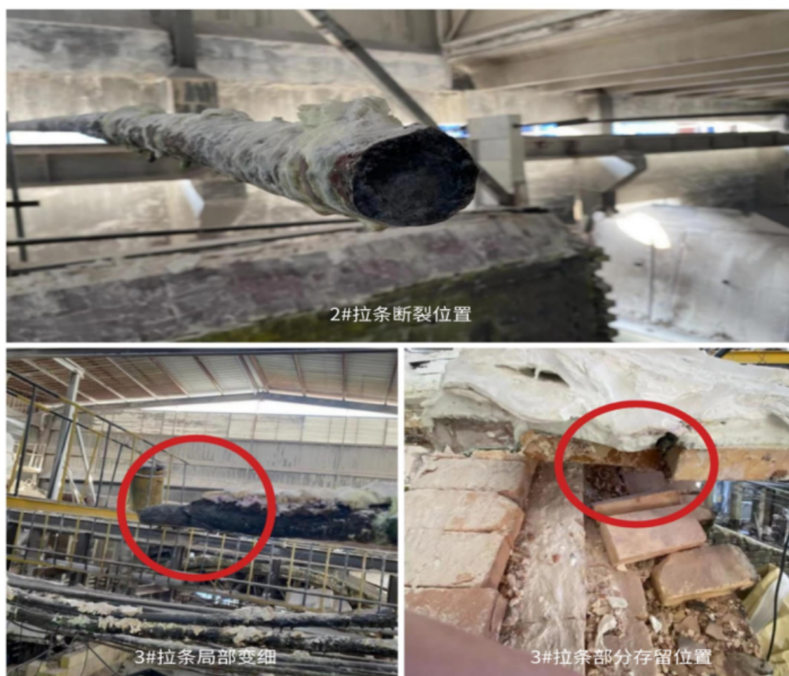
图 8 拉条断裂及局部变细图
