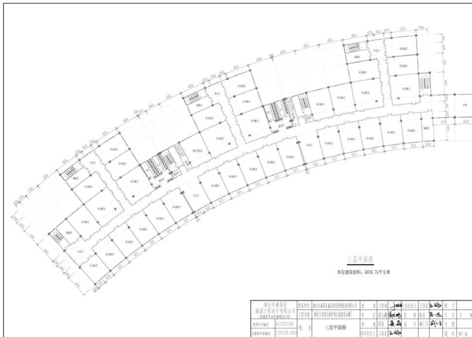
图 3.2.1-6c 技能培训楼 1 平面布置图（三层）
