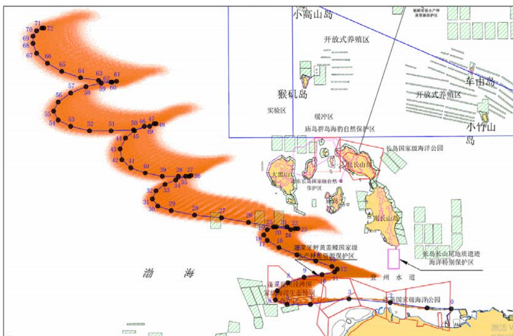
图 6.3.1-4c 溢油轨迹和最大影响范围图 (SE 风, 高潮时溢油)
