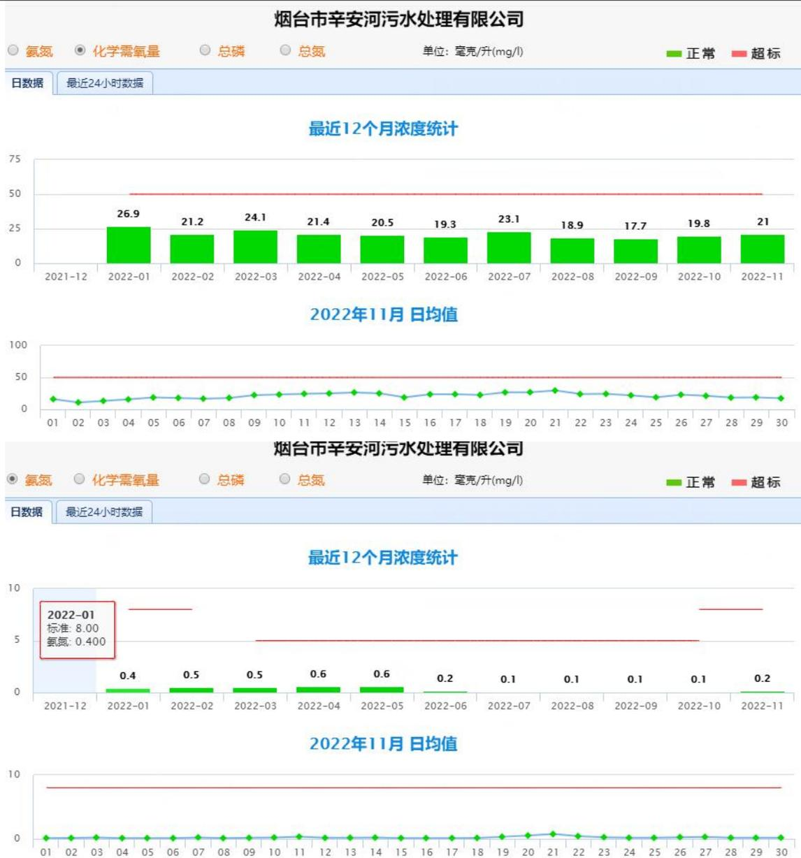
图5 辛安河污水处理厂COD、氨氮出水水质达标情况（摘自省厅自动监控平台）
