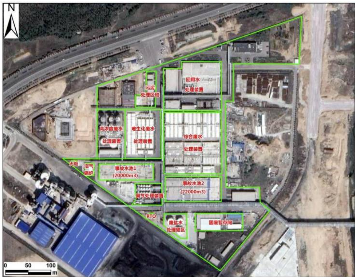
图2.2-1 万华环保科技西区污水处理站平面布置俯瞰示意图
