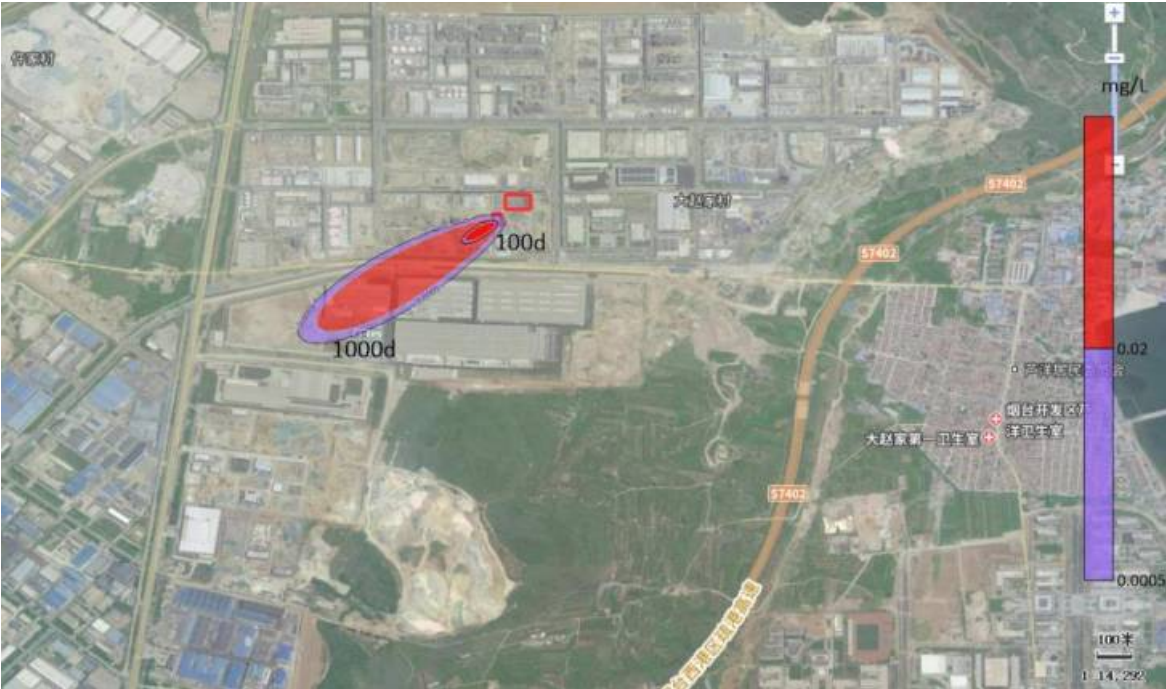
图7.4-1 工况 1（平面连续点源持续泄漏）情况下二氯甲烷超标和影响范围示意图
