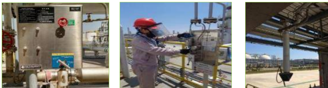
图2.2-16 密闭采样器密闭采样装车密封
