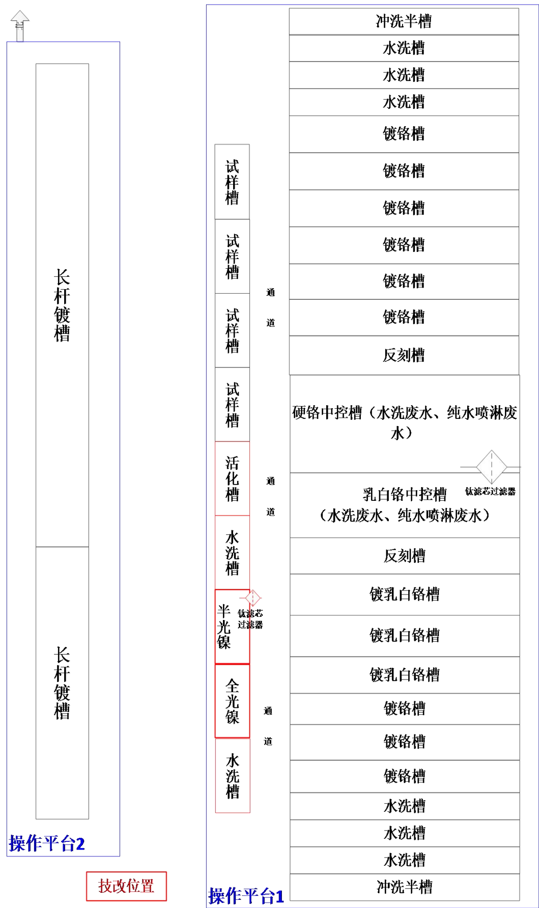
图 2.3-3 电镀槽平面布局图
