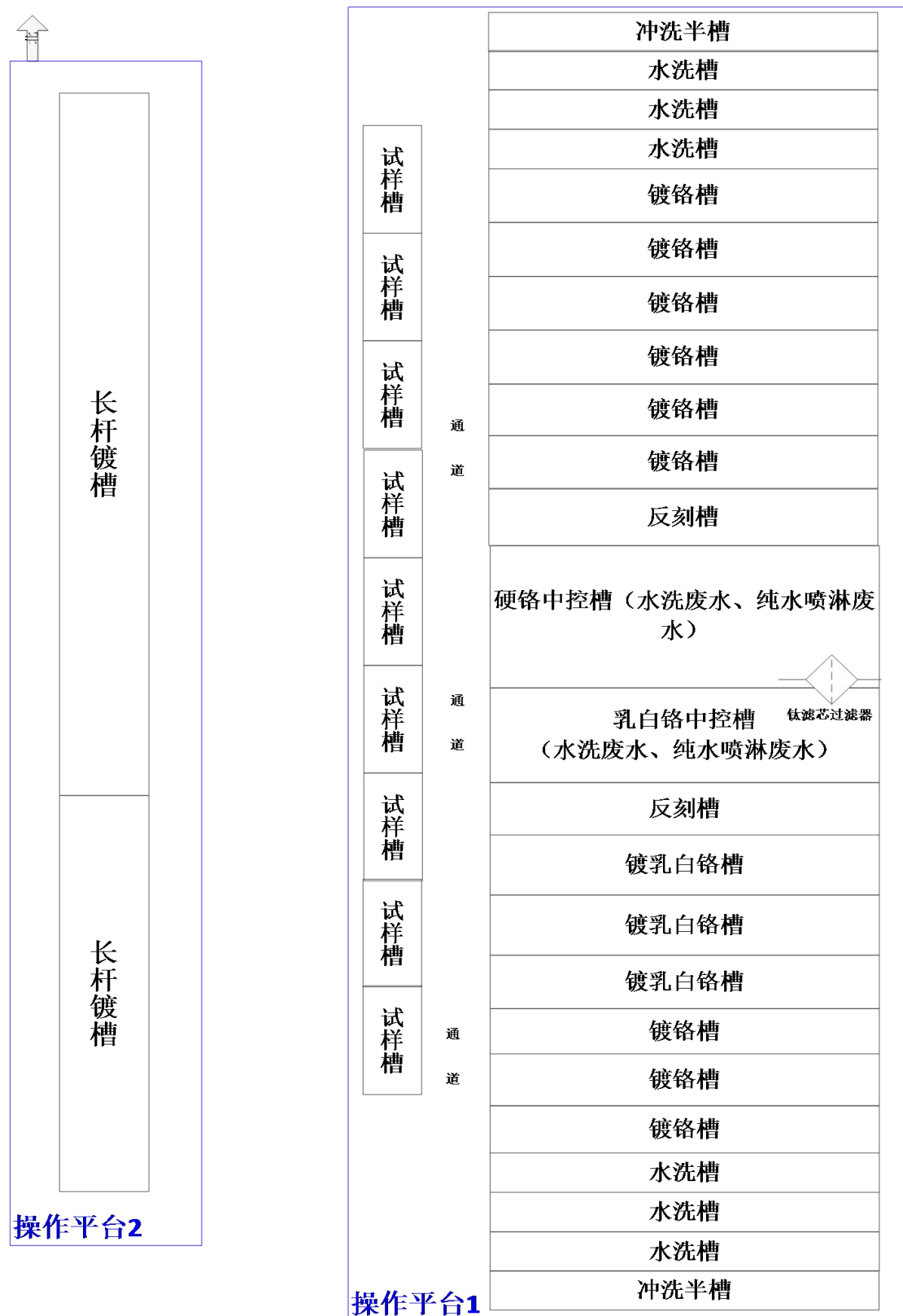
图 2.2-5 电镀槽平面布局图
