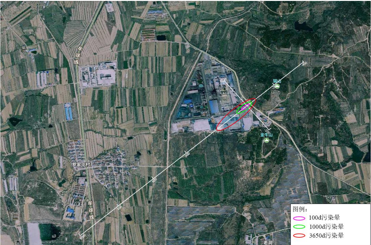
图 5.4-4 砷瞬时泄漏污染晕分布示意图 单位：m
