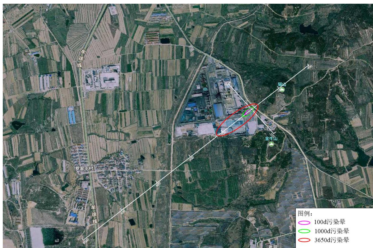
图 5.4-8 镉瞬时泄漏污染晕分布示意图 单位：m
