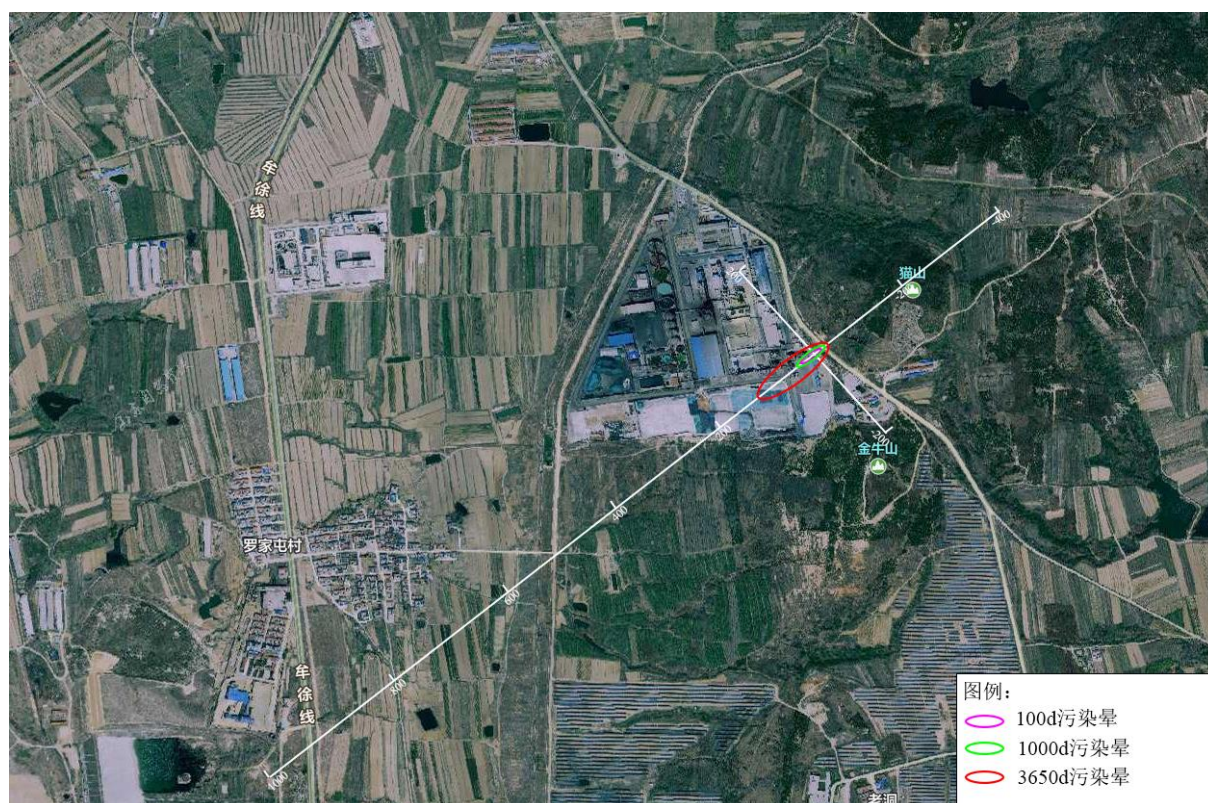
图 5.4-6 铅瞬时泄漏污染晕分布示意图 单位：m
