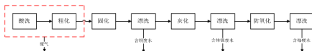
图 2-7 (b) 高速高频板 5G 用（HVLP）铜箔表面处理工序工艺流程图
