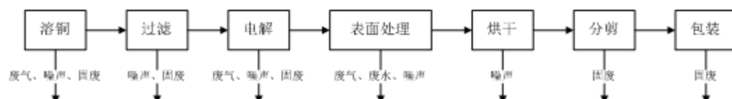
图 2-7 (a) 高速高频板 5G 用（HVLP）铜箔生产工艺流程图
