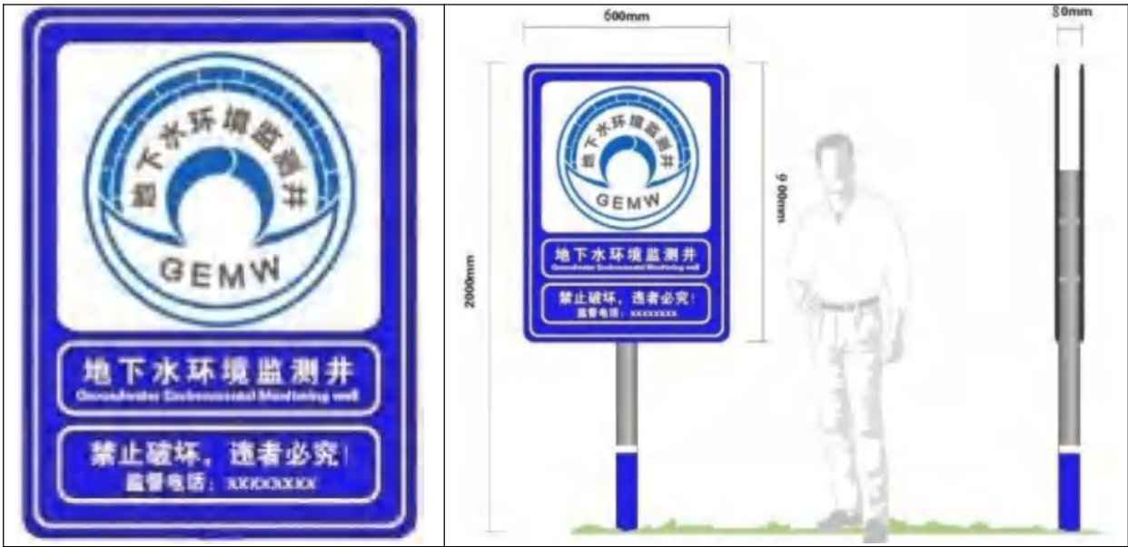
图 5.4-14 地下水监测井标识牌设置图示
