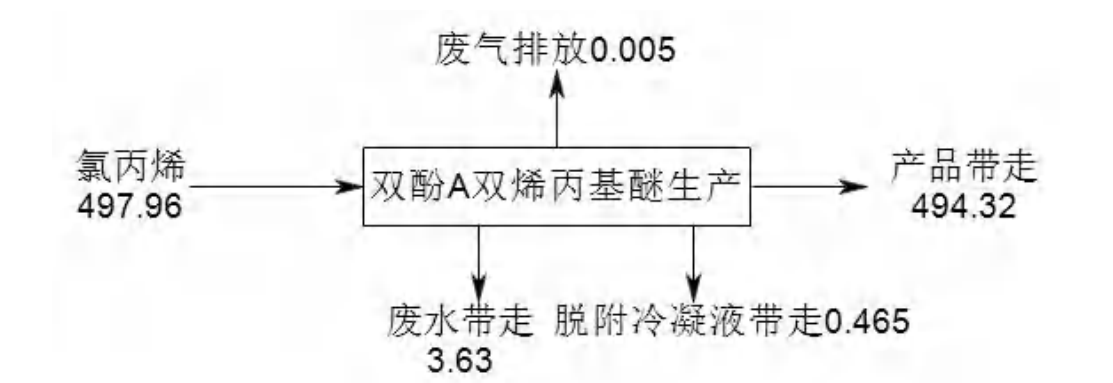
图 3.3-21 车间烯丙基氯物料平衡图 (t/a)
