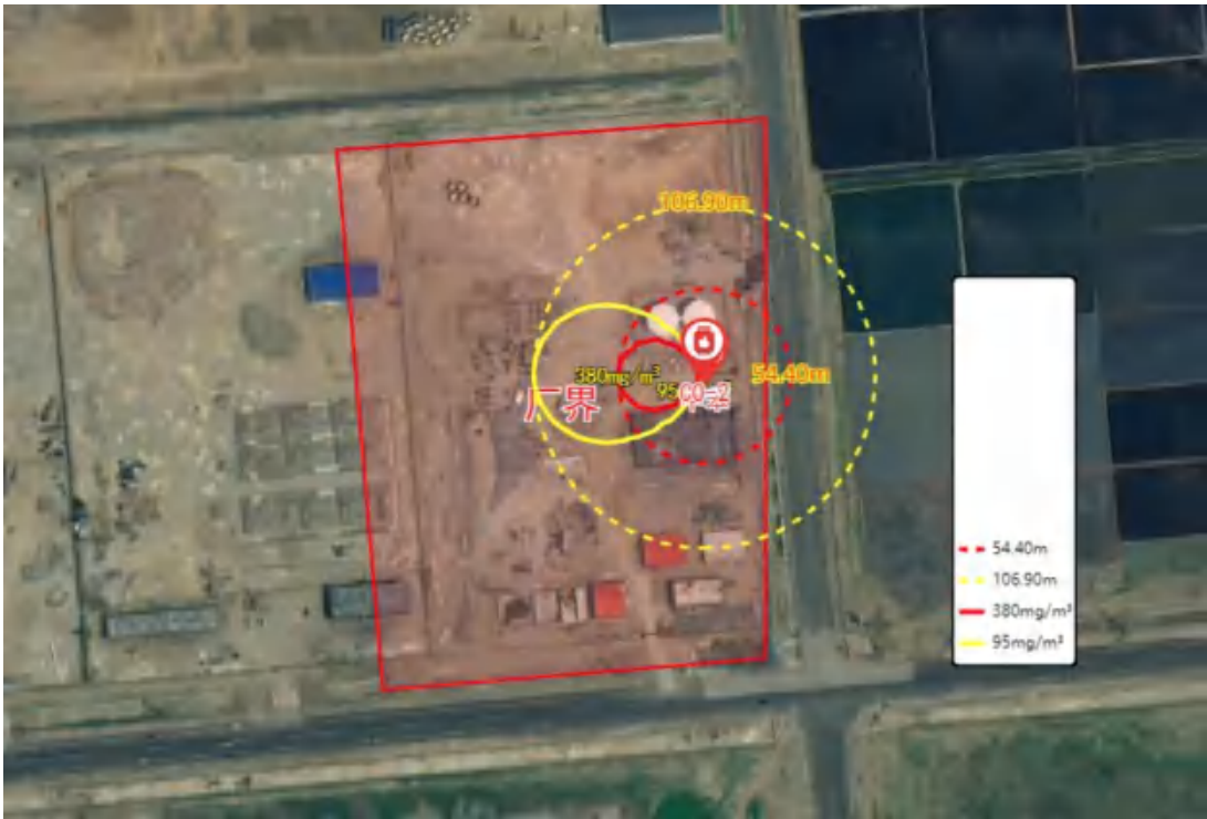
图 6.5-7 甲苯储罐泄露次生 CO 扩散预测最大影响范围图
