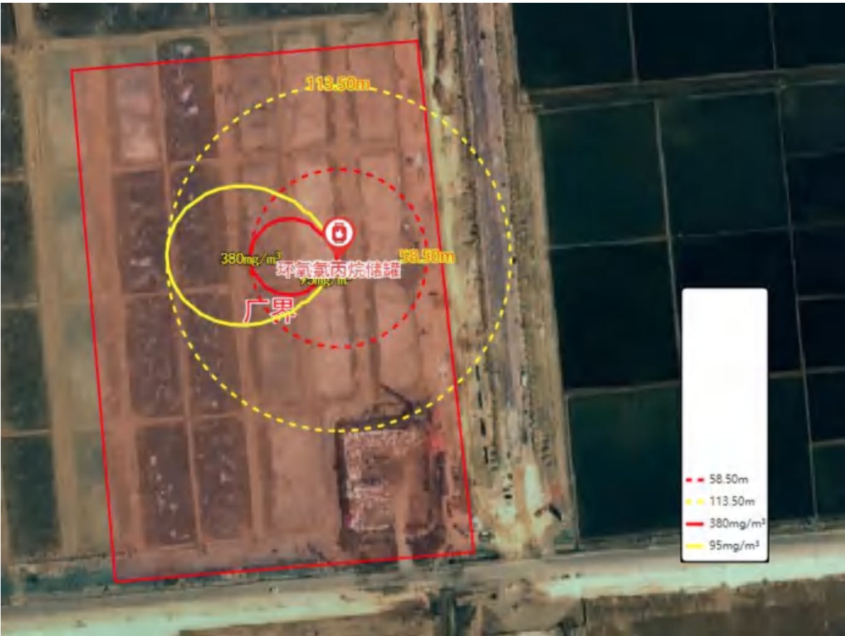
图 6.5-4 环氧氯丙烷储罐泄露次生 CO 扩散预测最大影响范围图
