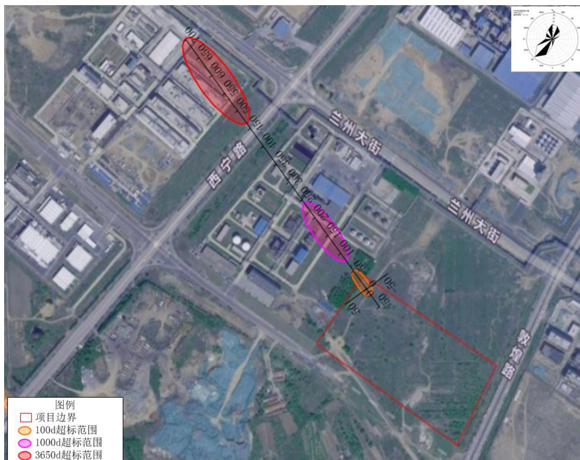
图 6.2-2 瞬时渗漏时 COD 污染晕分布示意图
