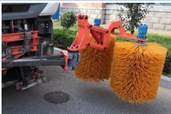
图 6.7 护栏清洗装置装车调试
