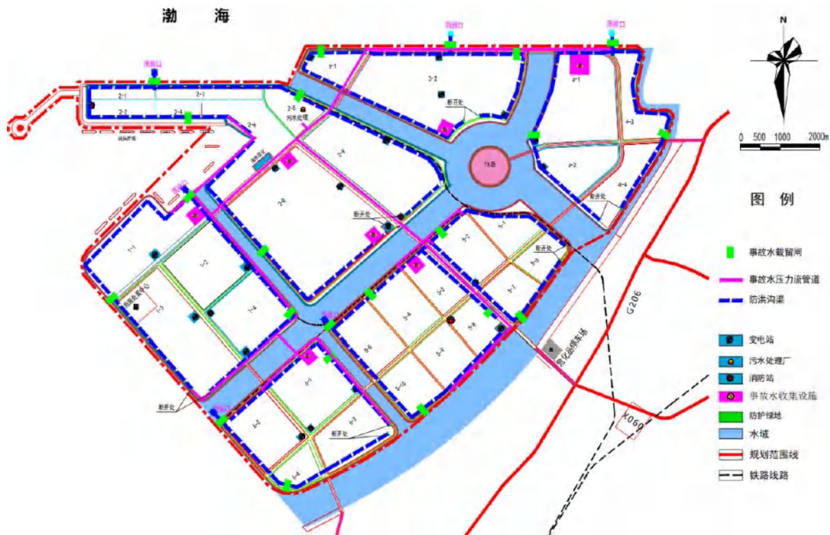
图 6.7-4 三级防控体系及事故废水导排示意图
