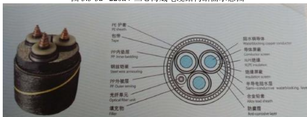
图 3.3-3b 66kV 三芯海底电缆结构断面示意图
