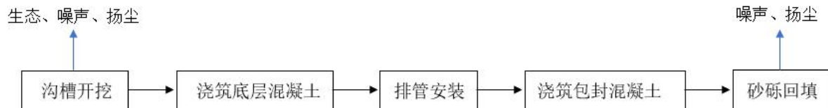
图 4.1-5a 陆缆（排管）施工工序和产污环节图
