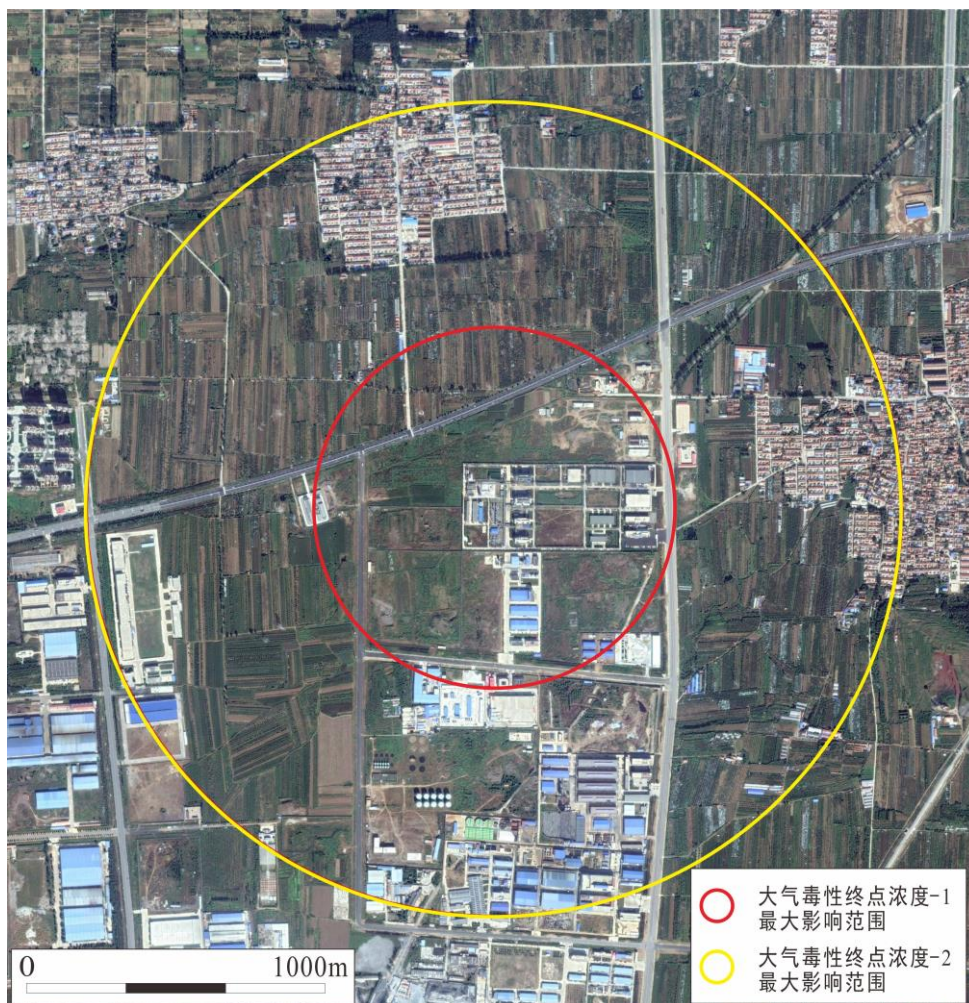
图 10.7-7 醋酐储罐泄露发生火灾事故时次生 CO 最大影响范围图(最不利气象)
