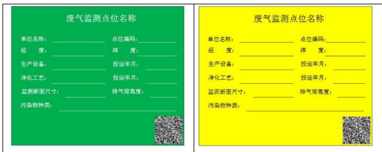
图 15.4-3 提示性废气监测点位标志牌（左侧）与警告性废气监测点位标志牌（右侧）
