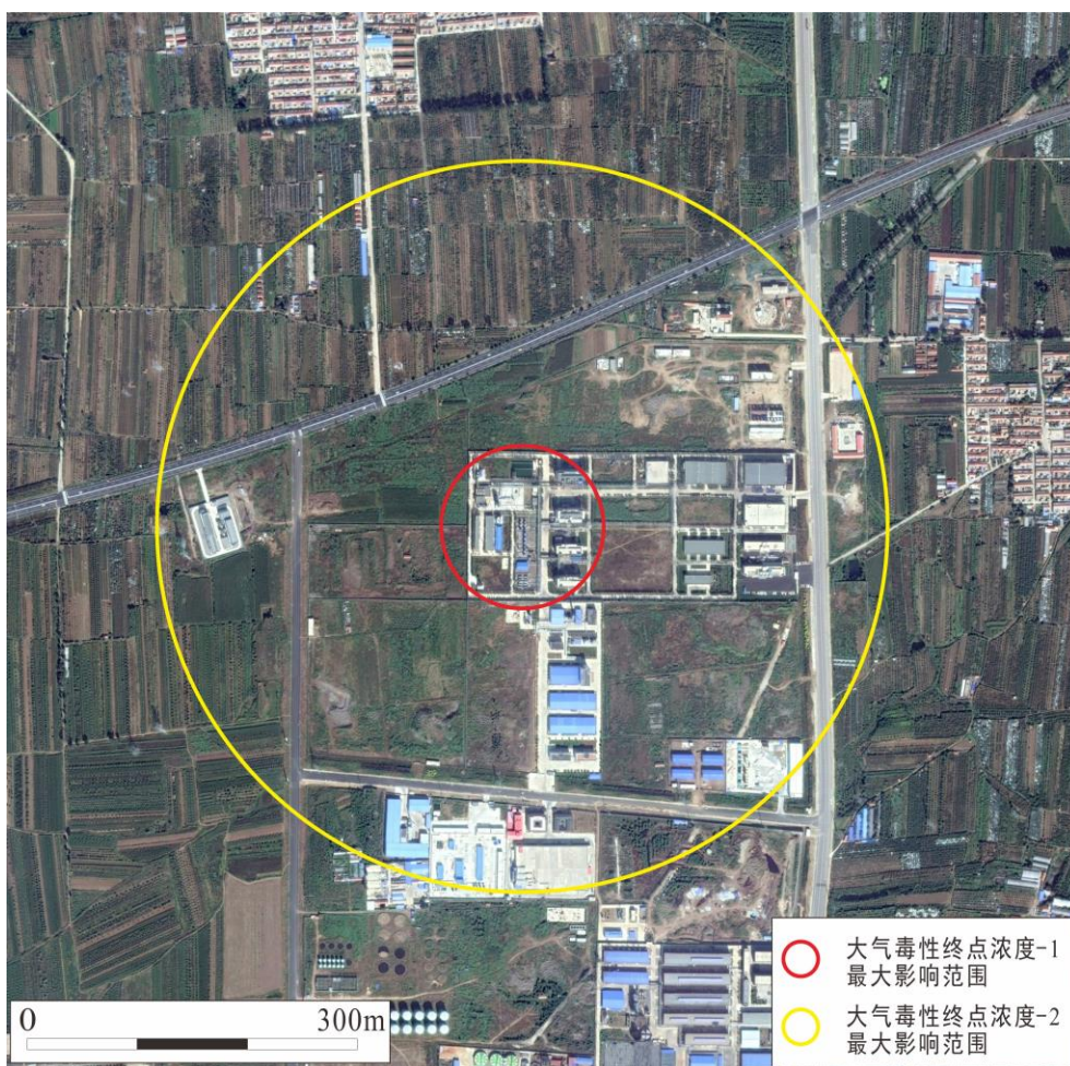
图 10.7-1 丙烯腈储罐发生泄露事故时丙烯腈最大影响范围图（最常见气象）
